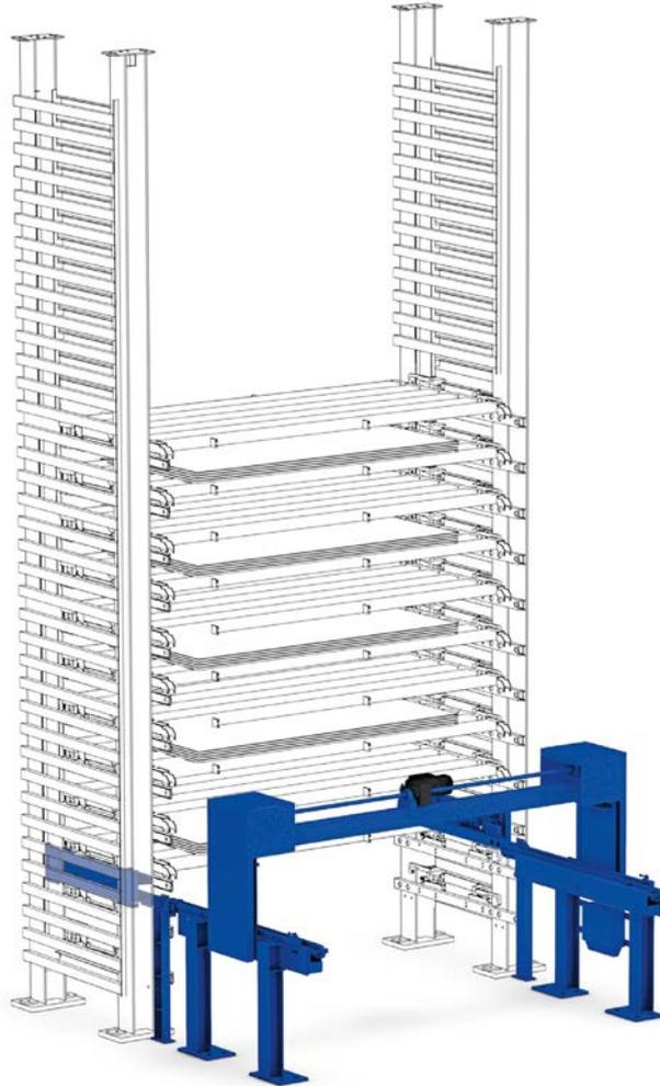
**Der SCHNELLWECHSLER ist ein einfaches Pufferlager-System, das Ihnen die schnellstmögliche Bereitstellung von Rohblechen und anderen Gütern ermöglicht.**
